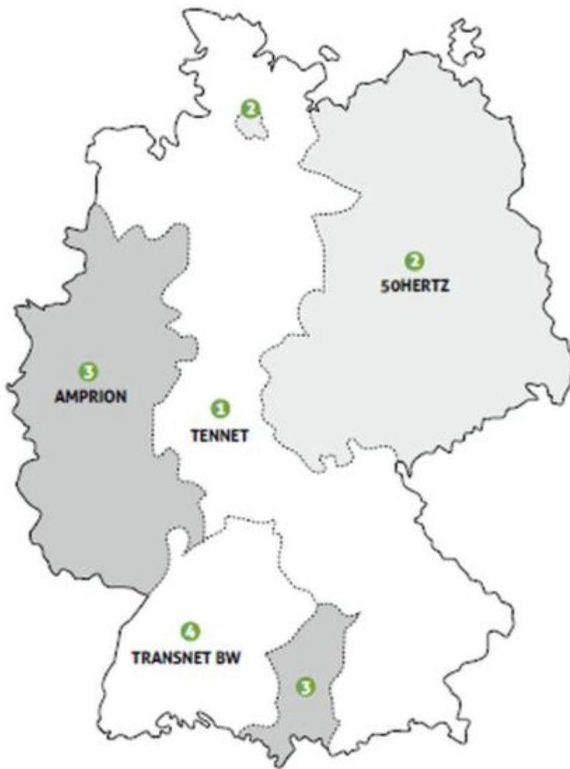
Bild 2: Die vier Regelzonen des deutschen Stromnetzes
