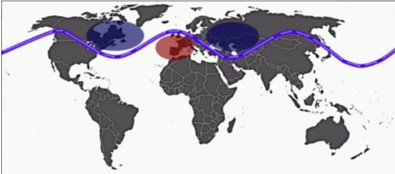
Abb. 4 | Starker zonaler Grundstrom mit langen Wellen der Wellenzahl 3. Die Folge eines solchen Langwellensystems ist eine milde Witterung in Mitteleuropa auch in den Wintermonaten.
